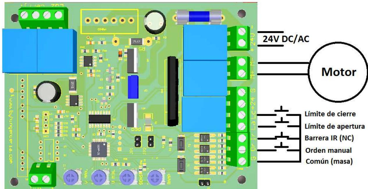
Las borneras “Contacto Luz” y “Contacto Cerradura” son contactos de relé, no entrega ningún tipo de tensión.
